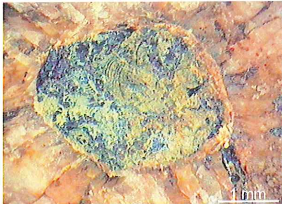
Obrázek 7.8: Oválné zrno allanitu zatlačované od okrajů žlutohnědým ancylit. Na povrchu zrna žlutozelený agregát směsi montmorillonitu s rabdofánem. V okolí tlakově rozpraskaný oligoklas. Vlastějovice. Makrofoto.
